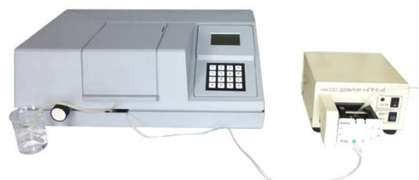
Рис. 3. Фотоэлектрический фотометр КФК-3-01-“ЗОМЗ” (слева) с проточной гидравлической системой и перистальтическим насосом НПСМ-4 (справа)
