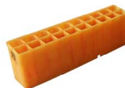
Рис. 2. Двухрядная аналитическая кассета КА для автомата подачи проб ПА-2 (объем ячейки 10 см 3 )
