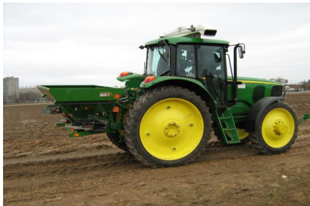
Рис. 4. Роботизированный агрегат для дифференцированного внесения удобрений
