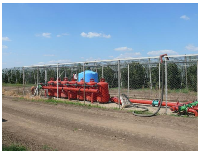
Рис. 2. Система подготовки воды и растворный узел для приготовления питательного раствора для фертигации с капельным поливом в интенсивном саду яблони
