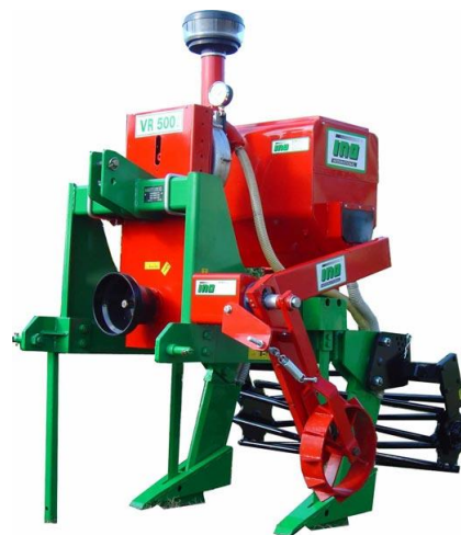
Рис. 3. Вибрационный глубокорыхлитель VR 500 (Словения) для локального, в щели глубиной до 40 см, в две строки, подпочвенного внесения твёрдых гранулированных удобрений
