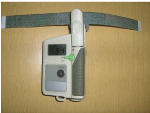
Рис. 2. Фотометр «Yaга» с полоской бумаги, вырезанной из дистанционного снимка поля с озимой пшеницей, выполненного обычной цифровой камерой с БПЛА
