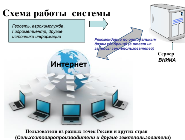
Рис. 6. Принципиальная схема работы интерактивных программ по автоматизированному расчету оптимальных доз минеральных удобрений
