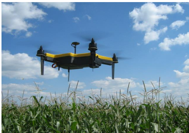
Рис. 5. Беспилотный летательный аппарат (квадрокоптер) на диагностическом определении обеспеченности азотом посева кукурузы
