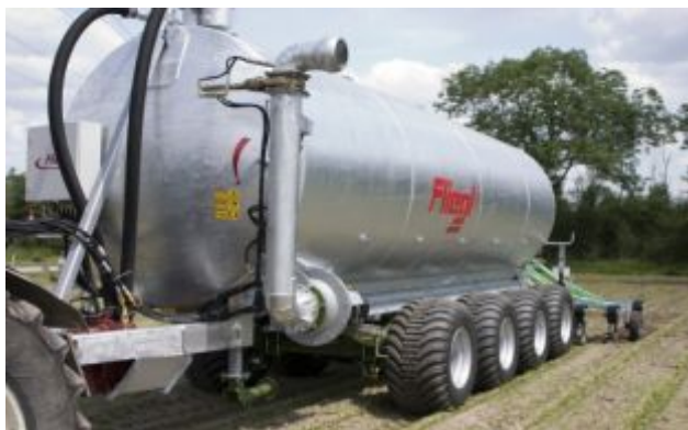
Рис. 2. Многотоннажная цистерна для внесения бесподстилочного навоза (поставляется ООО «Флигель Рус», г. Орел)
