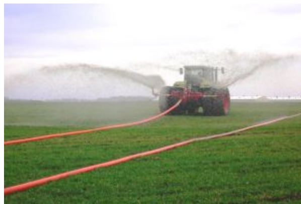
Рис. 3. Шланговая система внесения бесподстилочного навоза
