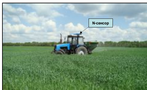
Рис. 5. N-сенсор фирмы «Yara»
