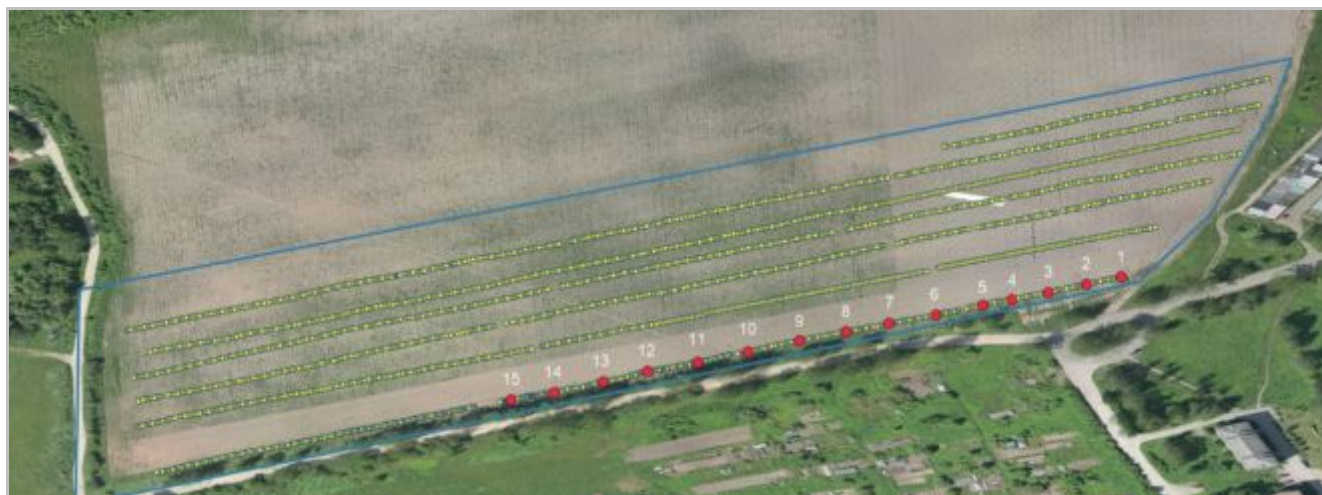
Рис. 2. Фрагмент расположения точек измерения в движении мобильным комплексом (желтые) и точек отбора образцов (красные) для градуировки измерительного блока на экспериментальном поле (Ленинградская обл.)
