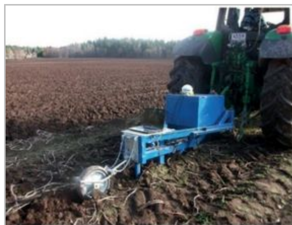
Рис. 1. Мобильный комплекс для измерения в движении агрофизических характеристик пахотного слоя почвы
