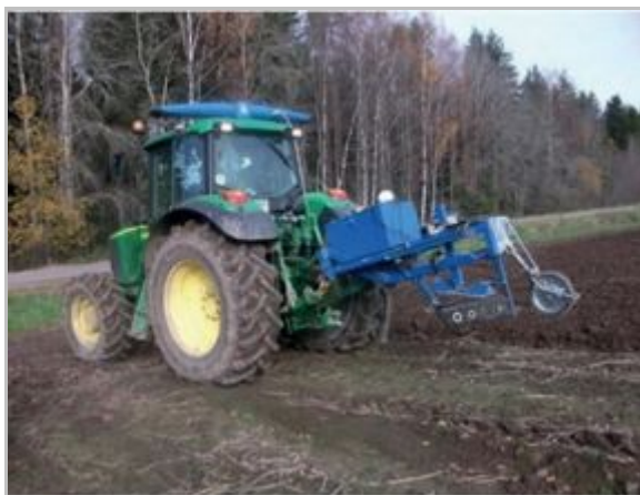
Рис. 1. Мобильный комплекс для измерения в движении агрофизических характеристик пахотного слоя почвы
