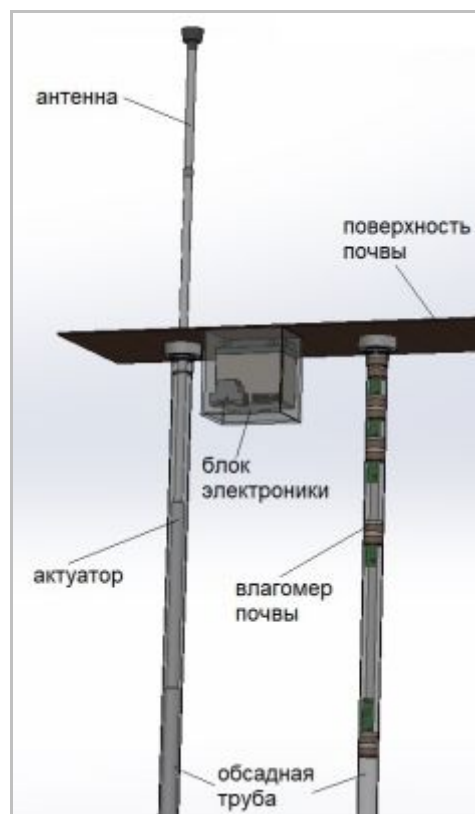
Рис. 6. Схема размещения сенсорного узла под поверхностью земли
