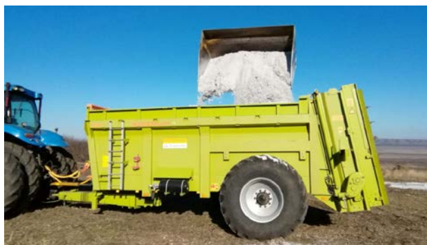
Рис. 3. Тестирование пригодности РОУМ-14 для проведения гипсования на полях ИП Главы КФХ Сабынина Г. К. Андроповского округа
