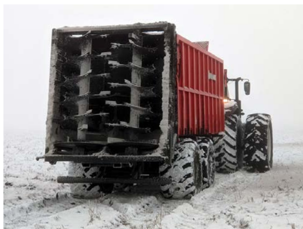
Рис. 4. Внесение фосфогипса разбрасывателем UMEGA PI 20 на полях ИП Главы КФХ Сабынина Г. К. Андроповского округа
