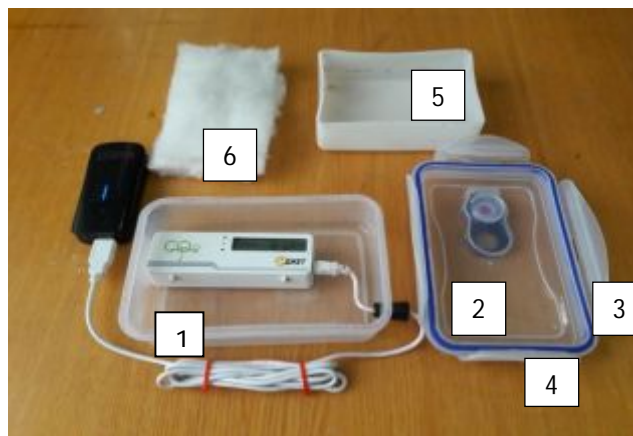
Рис. Конструкция портативного почвенного респирометра:
