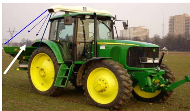
Рис. 9. Работа системы N-Sensor ALS с машиной для внесения удобрений
